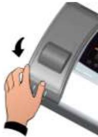
**Fig. 4:** Abra la parte frontal de la caja levantándola y desplazando las dos bisagras hasta el final de carrera.
