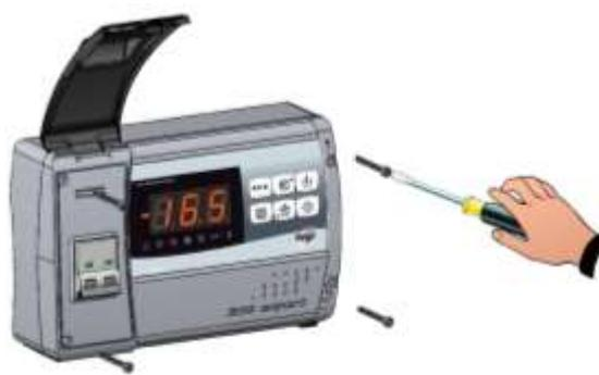
**Fig. 3:** Cierre la puerta transparente de protección del interruptor magnetotérmico diferencial.
