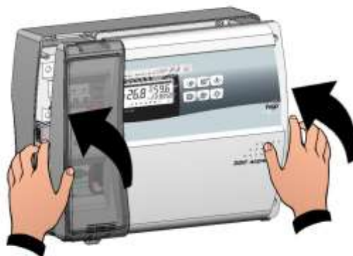
Fig. 15: Den vorderen Deckel schließen und dabei darauf achten, dass die Kabel sich im Inneren des Gehäuses befinden und dass die Dichtung des Gehäuses korrekt in der Aufnahme sitzt.
