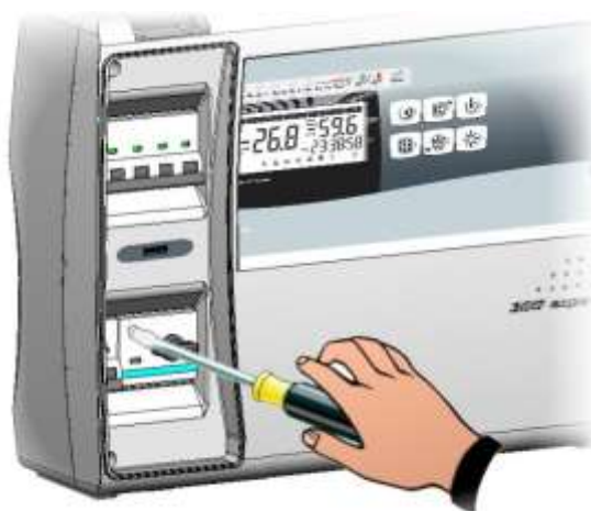
Fig. 14: Die Eichung des Motorschutzes je nach erfasster Absorption durchführen. In jedem Fall darf der eingestellte Wert nicht höher als der vom Hersteller des Verdichters vorgesehene Höchstwert sein.
