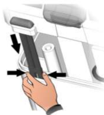
Fig. 11: Den Vorderteil am Boden des Gehäuses erneut einhängen und die beiden Scharniere in die entsprechenden Aufnahmen einsetzen.
