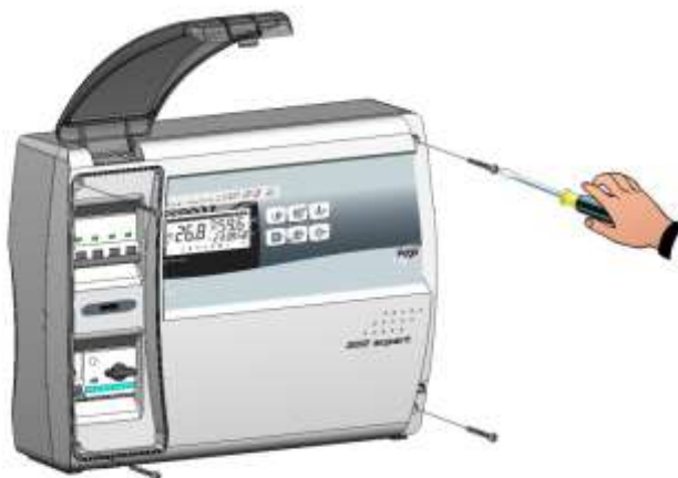
Fig. 16: Den vorderen Deckel mit den 4 Schrauben unter. Die Abdeckung der Schrauben auf der rechten Seite erneut positionieren.
