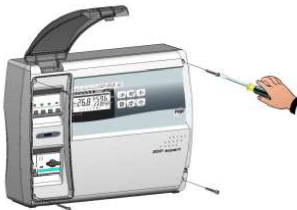
Fig. 2: Die 4 Befestigungsschrauben des Vorderteils des Schaltkastens abschrauben.
