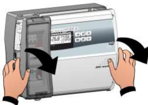
Fig. 3: Den Vorderteil des Schaltkastens öffnen und erheben und die beiden Scharniere bis zum Anschlag gleiten lassen. Die Scharniere biegen und zum Zugang zum Inneren des Schaltkastens um 180° nach unten drehen.
