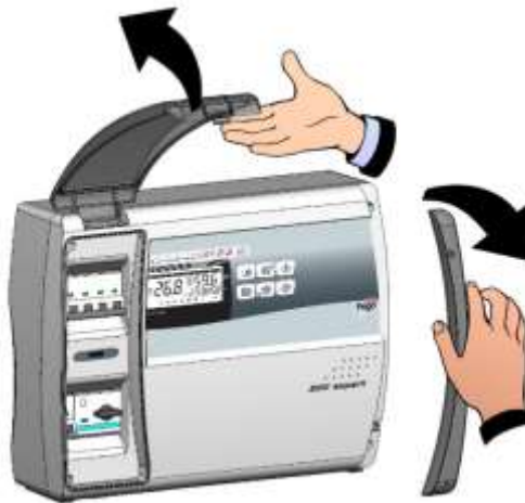
Fig. 1 : Soulever la porte transparente de protection du disjoncteur magnétothermique général et enlever la couverture des vis sur le côté droit.
