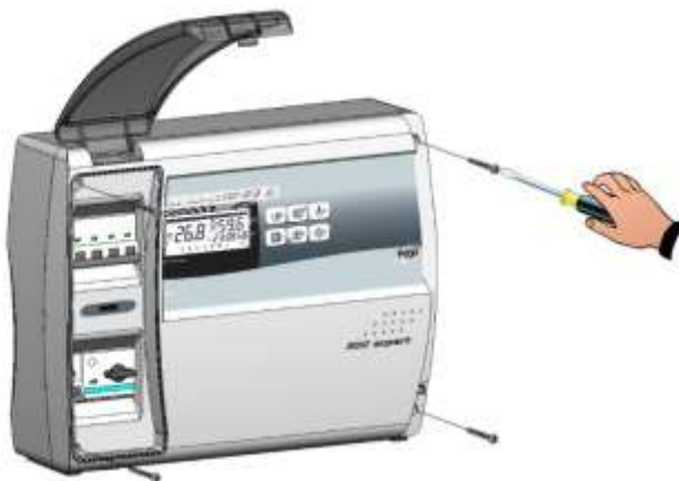
Fig. 16 : Fermer le couvercle frontal avec les 4 vis. Remettre en place la couverture des vis sur le côté droit.
