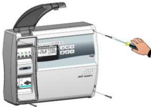
Fig. 2 : Dévisser les 4 vis de fixation du devant du tableau électrique.
