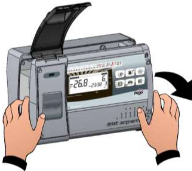
Fig. 3 : Ouvrir le devant du boîtier en soulevant et en faisant coulisser les deux charnières jusqu'à la butée d'arrêt. Fléchir les charnières et tourner le devant de 180° vers le bas, pour accéder à l'intérieur du tableau Open the front of the box, lift it and slide the two hinges out as far as they will go. Bend the hinges and rotate the front panel by 180° downward to get access inside the panel
