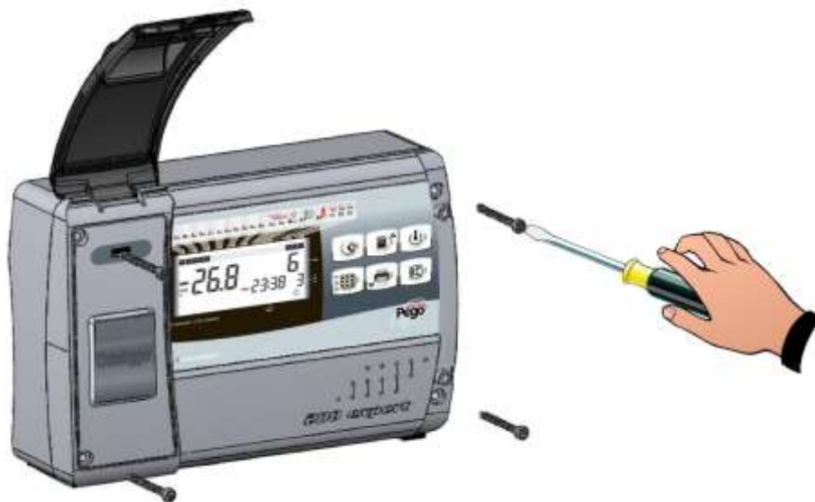
Fig. 2 : Dévisser les 4 vis de fixation du devant du boîtier.
