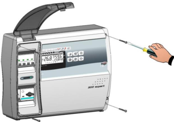
Fig. 2: Svitare le 4 viti di fissaggio del frontale del quadro elettrico.
